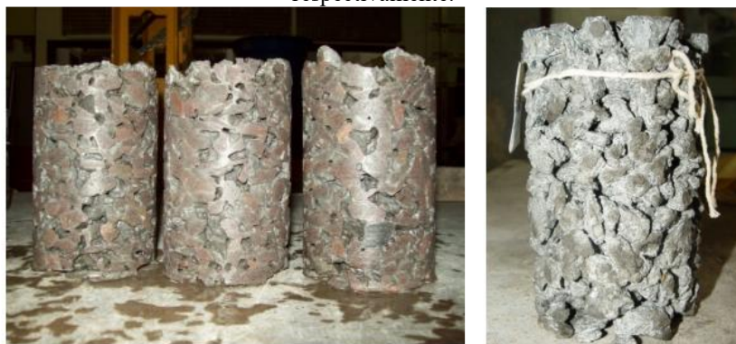
Figura 28: Aspecto visual de corpo de prova extraído de bloco de concreto e corpo de prova moldado, respectivamente.
