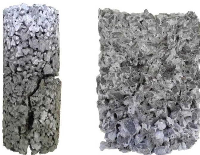
Figura 35: Ruptura à tração indireta e seção de fratura de concreto com duas camadas de compactação.
