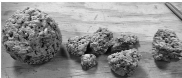
Figura 33: Produto de cascalho de rio PCPC após 500 revoluções.
