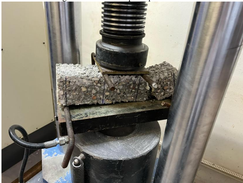
Figura 56: Prisma rompido após o ensaio.
