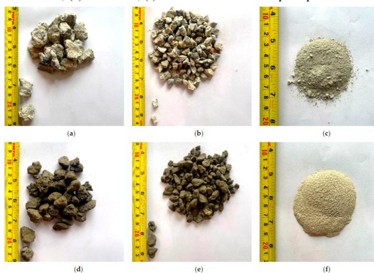
Figura 38: Componentes da matriz dos RPCs em estudo: (a) 3/4” RCA; (b) 3/8” RCA; (c) Cimento CPC30R; (d) 3/4” RAP; (e) 3/8” RAP; (f) Areia de sílica menor que a peneira nº 0.
