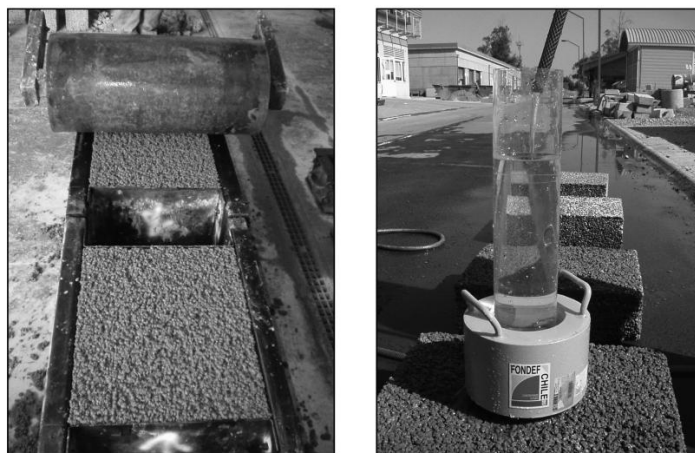
Figura 13: Compactação nos moldes e ensaio com permeâmetro de carga variável, respectivamente.
