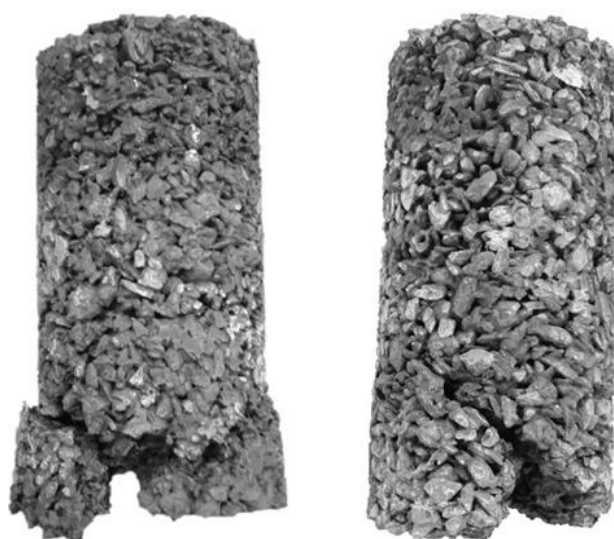
Figura 36: Ruptura à tração indireta e seção de fratura de concreto com três camadas de compactação.
