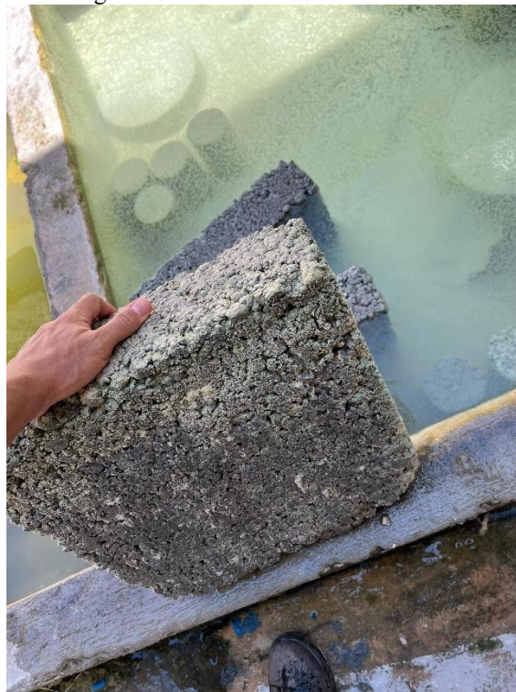
Figura 49: Processo de cura dos blocos.
