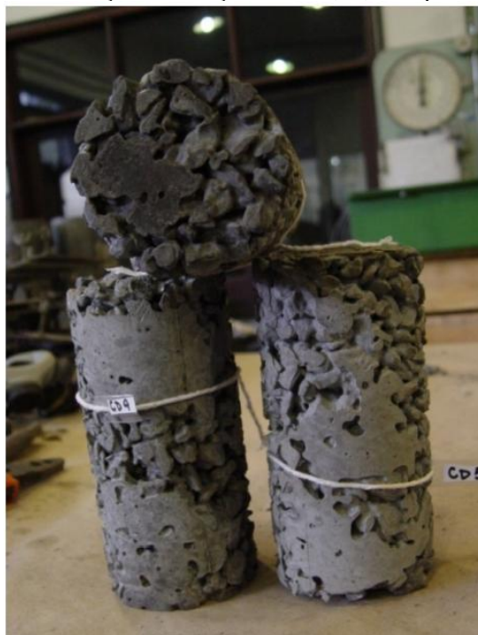
Figura 27: CPs do traço com relação a/c de 0,45, com poros obstruídos.
