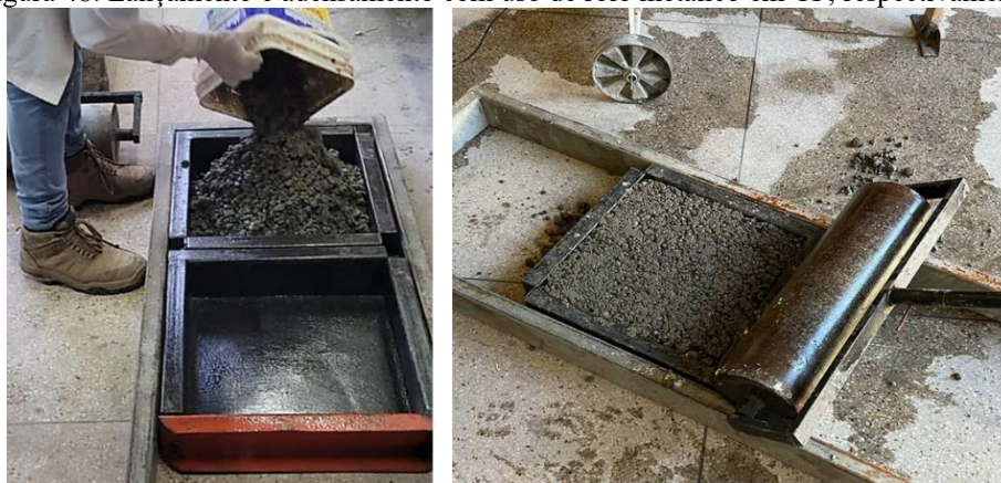
Figura 48: Lançamento e adensamento com uso de rolo metálico em CP, respectivamente.
